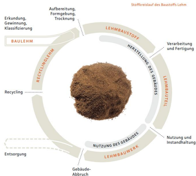
Bild 2: Stoffkreislauf des Baustoffs Lehm (lehmbau-info; Dachverband Lehm e.V. – Bundesverband zur Förderung des Lehmbaus, März 2014)
